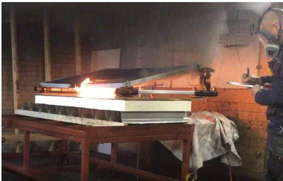
Les tests ont été effectués selon les principes CLC/TR 50670<sup>15</sup>. Un brûleur à gaz a été placé et allumé entre le panneau PV et la toiture.
